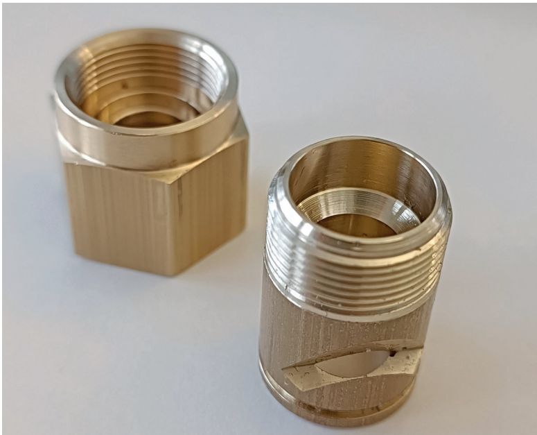
Auf Kupplungsstücken aus bleifreiem Messing CW724R sind Gewinde M18 x 1 zu fertigen
